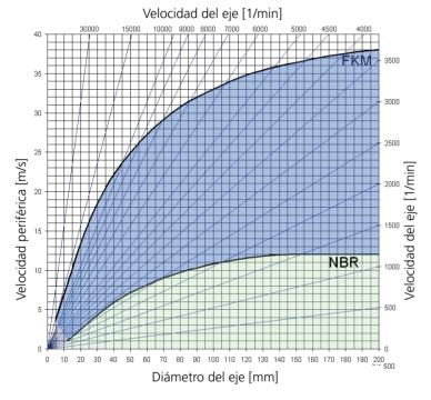
El diagrama se refiere a un funcionamiento sin presión y en condiciones favorables de lubricación y disipación del calor (tipo OS-F10).
