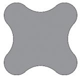
**Las juntas en X** son elementos de sellado circulares de doble efecto con una sección cuadrada en forma de X.
